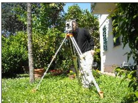
Eseguiamo rilievi topografici con strumentazione GPS Leika, con stazione totale Sokkia Set6S, livello ottico di Sokkia C330 per l'esecuzione di rilievi topografici e misure piano altimetriche
