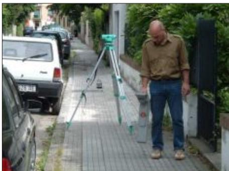
Attraverso l'utilizzo di strumenti ad induzione magnetica (radiodetection Limited) siamo in grado di localizzare la posizione e la profondità di reti tecnologiche interrante (sottoservizi) e tubazioni metalliche in genere.
