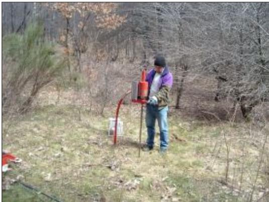
Geoprospezioni è dotata di penetrometro dinamico COMPAC PENNI 30 per l'esecuzione di prove SCPT. La maneggevolezza della nostra attrezzatura ci consente di realizzare prove penetrometriche di tipo DPM anche su terreni di difficile accesso e su versanti scoscesi, oltre che campionamenti continui di terreno a modesta profondità.
